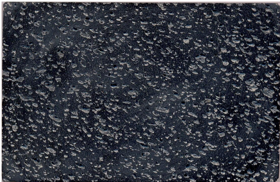
Placa cortada de basalto vesicular de composición toleítica en la localidad Loma Larga, población de San Felipe de Los Herreros, Mpio. de Charapan.
